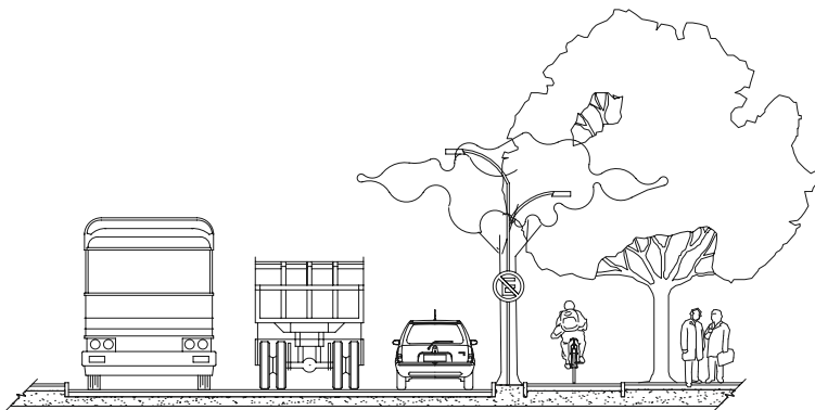
Figura 39. Corte esquemático. As vias devem ser desenhadas de forma que a proximidade entre os diversos meios de transporte seja compatível com a massa e velocidade de cada um deles.
